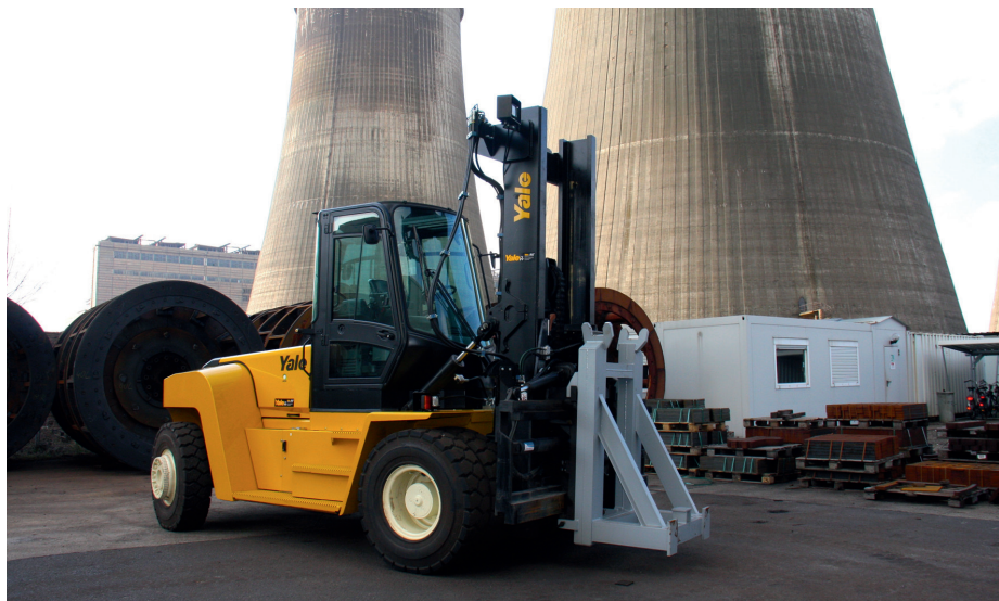
③ Damit der Stapler das Schlagrad wieder exakt in die Aufhängung in der Mühle einsetzen kann, hat Yale das Fahrzeug mit einer speziellen Aufnahmevorrichtung ausgestattet.
