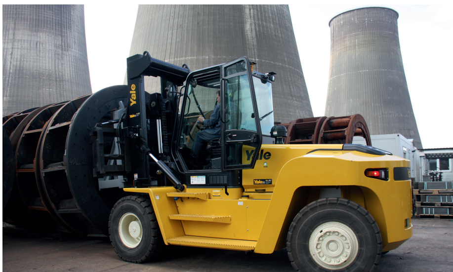
② Der Yale-Dieselstapler GDP160 EC mit beheizter Kabine und einem Drehsitz wird bei FSK für die Instandsetzung der Mühlen eingesetzt.
