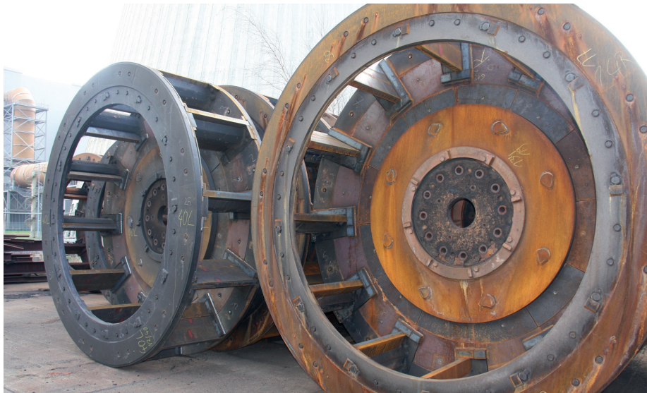
① Nach einer Vorzerkleinerung der Rohbraunkohle wird diese in die Schlagräder der Kohlemühlen geschüttet und durch Schlagplatten zu feinem Braunkohlenstaub zermahlen.
